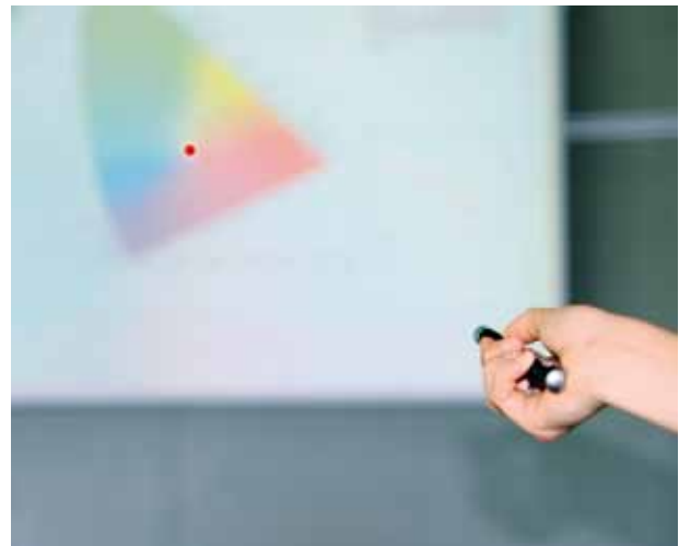
1 Laserpointer sind beliebt, bergen aber ein erhebliches Risiko in sich, wenn sie direkt in die Augen gerichtet werden: Ihre Strahlung kann Augenleiden hervorrufen und im Extremfall Blindheit verursachen.
